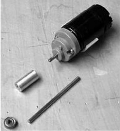
Zum Einbau benötigt man lediglich etwas Restholz, einen Kabelbinder 160mm lang, ein Kugellager, eine Welle und eine Kupplungsbuchse (Kosten ca. DM 20.-).
