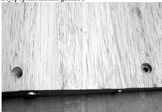
Nach dem Verschleifen werden die Löcher senkrecht von unten aufgebohrt und von oben mit einem Schleifstein im Durchmesser der Schraubenköpfe vorsichtig bis zu den Verstärkungen aufgeschliffen.
