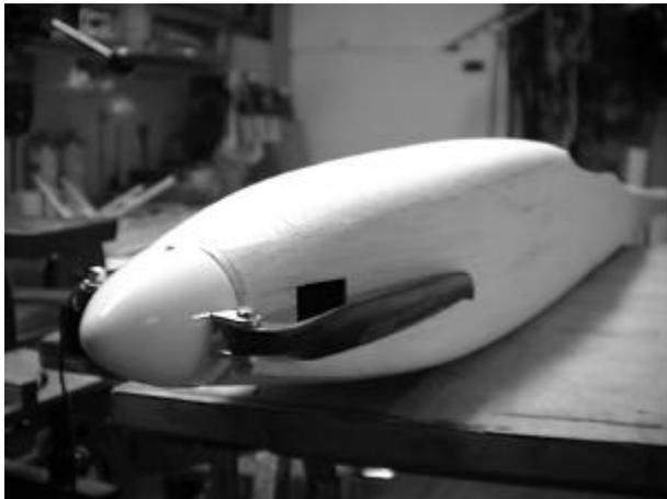
Beim Rohbau wird der Motorspant fluchtend eingeklebt. Das Lager wird erst nach dem Finish mit 4 Tropfen Klebharz befestigt. Mit dieser Antriebseinheit läßt sich durchaus ein Einbau in eine Rumpfspitze mit einem 44 mm Spinner realisieren.
