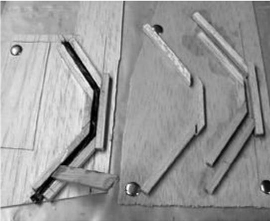
Zur Verbindung der Dämpfungsflossen benötigt man stabile, leichte Kulissen, die man sehr gut aus Kohlerowings und Polyesterharz herstellen kann. Auf ein Balsabrett klebt man zwei identische Formen aus 5x5mm Balsaleisten entsprechend der V-Stellung und des gewünschten Abstandes der Ruderhälften auf. Der Winkel beträgt ca. 110-120 Grad, die Breite richtet sich nach der Höhe von Nasen- und Endleiste der Ruderhälften.
