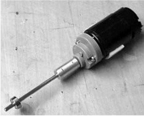
Vor dem Einbau muß die Kupplungsbuchse auf der meist mit Untermaß gefertigten Getriebewelle ausgerichtet werden, damit die verlängerte Welle nicht allzu sehr eiert. Dazu wird der Antrieb an eine Spannung von ca. 2 V angeschlossen und die beiden Madenschrauben gegenseitig so lange verstellt, bis man einen ruhigen Lauf ohne Seitenschlag erhält. Die Madenschrauben gut festziehen. Ein kleiner Tropfen Schraubensicherung leistet hier gute Dienste.
