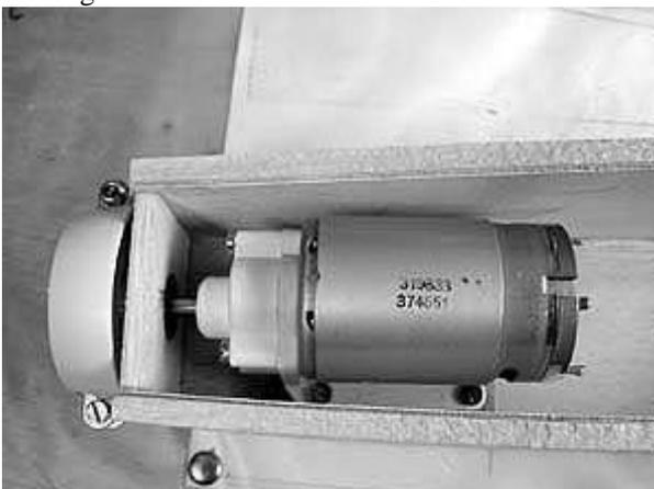
Der Antrieb wird so positioniert, daß die Antriebswelle weit genug übersteht, um bei vollständig aufgestecktem Spannkonus noch ca. 4 mm Abstand zwischen der Hinterkante des Spinners und Motorspant zu ermöglichen.
