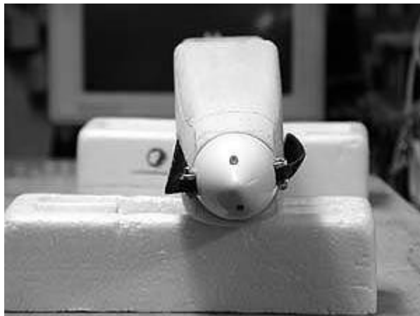
Mit dem 50mm Spinner kann man einen sauberen Rumpfübergang erzielen.
