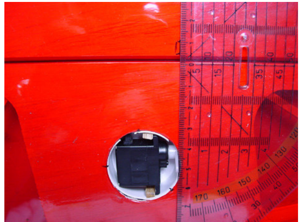
Anzeichnen des Ruderhorns. Die Anlenkung muss im rechten Winkel zur Drehachse des Ruders erfolgen
