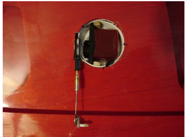
Aus 0,8mm Federstahl wird die Anlenkung gebogen. Zur Sicherung Innenseele mit Pattex auf das Drahtende kleben.
