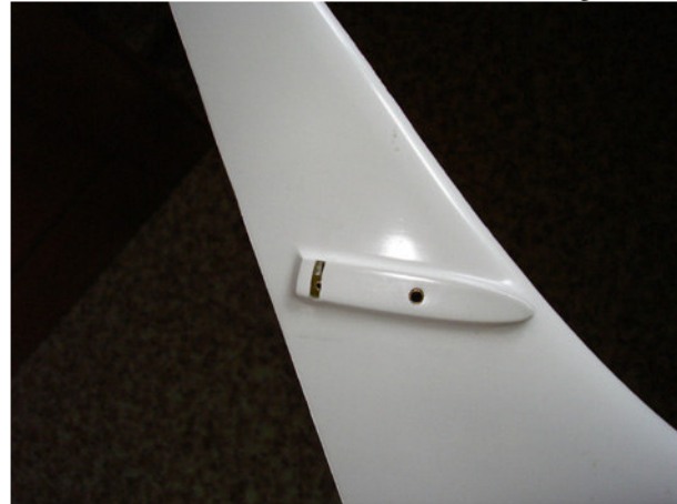
Der fertige Pendelruderhebel wird in die Seitenflosse eingefädelt.
